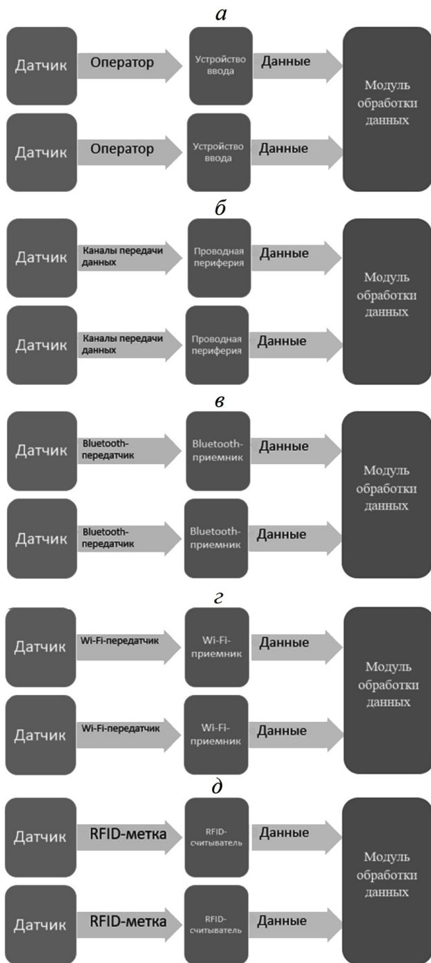
Рис. 3. Схема поступления информации при разных способах передачи данных: ручном ( а ), по проводу ( б ), с помощью Bluetooth ( в ), Wi-Fi ( г ) и RFID-технологии ( д )
