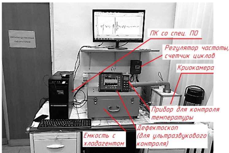
Рис. 1. Стенд для усталостных испытаний металлов в широком диапазоне температур
